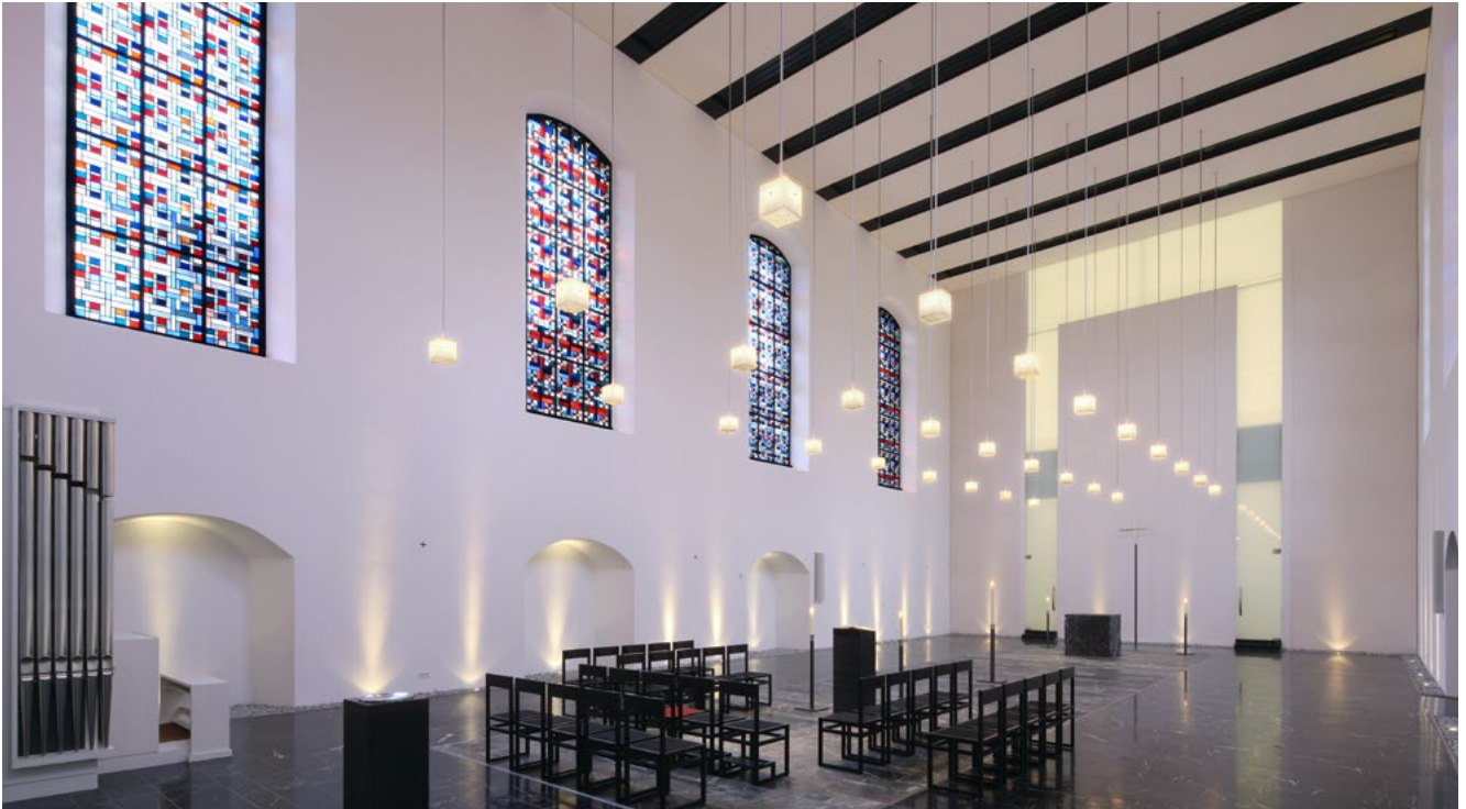
Bei der Neugestaltung des Kirchenraums wurden zwei Heizsysteme installiert. Die Fußbodenheizung dient der Grundtemperierung. Die Deckenheizung wird zum Gottesdienst zugeschaltet, um die Aufenthaltsqualität für die Besucher zu erhöhen. Der Clou: Sie ist in drei Zonen getrennt schaltbar.
