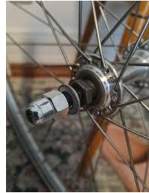
Der Abstand der äußersten Spitzen der beiden Hutmuttern rechts und links darf nicht größer als 19 cm sein. Breitere Hinterachsen passen nicht zwischen die Einspann-Vorrichtung.
